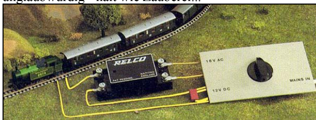
So wird der HF-Reiniger angeschlossen.
